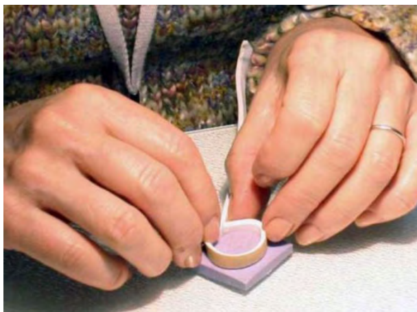
11. Вокруг матрицы формируется кольцо из пенопластовой ленты для создания стенки
