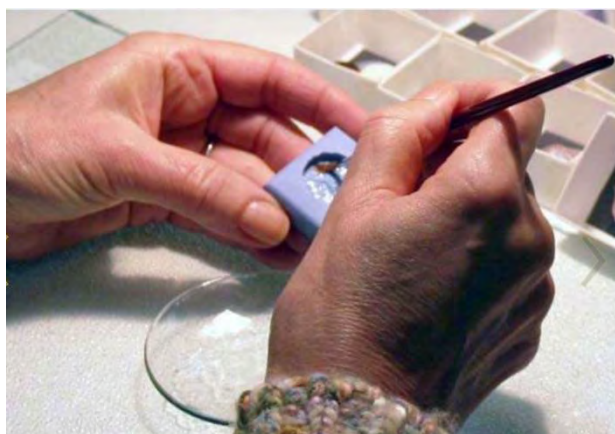
7. Антиадгезив наносится на матрицу, и оставляется до высыхания
