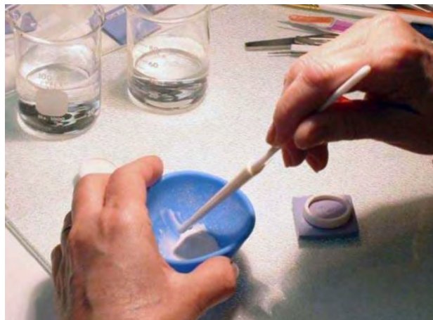
12. Гипсовая смесь смешивается с водой в пропорции 1:3
