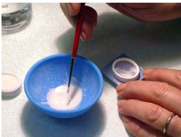
13. Гипсовая смесь наносится на изображение матрицы равномерным слоем, во избежание образования пузырьков
