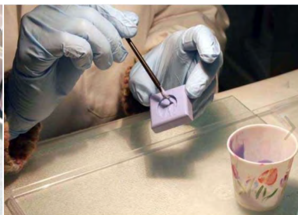
8. На изображение в форме силикон наносится ровным слоем, избегая образования пузырьков
